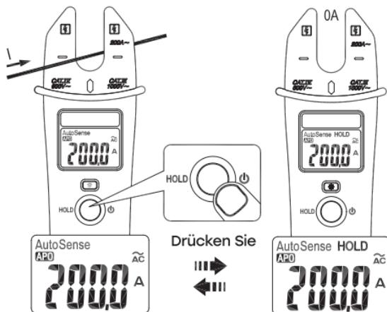
Data Hold ist nicht verfügbar, wenn „OL Ki2“ ohne Eingangssignale angezeigt wird.
