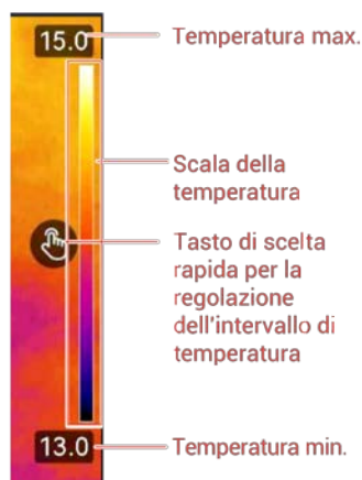
Figura 3-11 Regolazione livello o ampiezza
