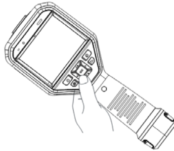
Figura 2-5 Controlli tramite pulsanti
